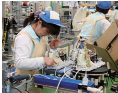
セル生産ライン方式による製造工程。開発当初、水に触れる箇所でも使用可能な樹脂コーティングによるハイブリッド型ICを採用。
