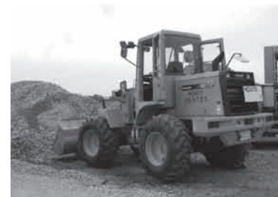
1.3m 3 タイヤショベルによる再生砕石積み込み
