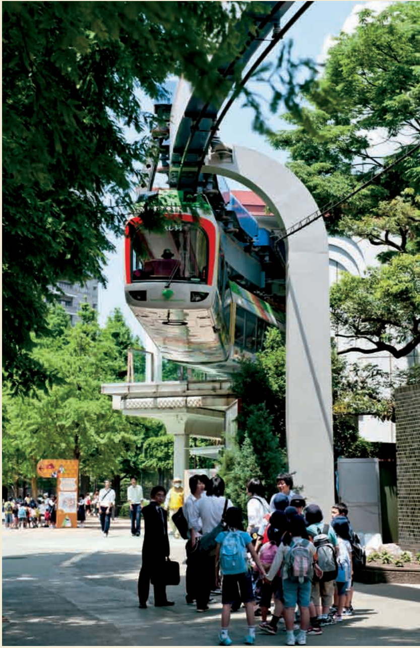
上野動物園のモノレールは、東京都交通局が日本車輛と共同で研究開始した上野式と呼ばれる独自方式により園内輸送施設の上野懸垂線として設置された。1957(昭和32)年開業。
