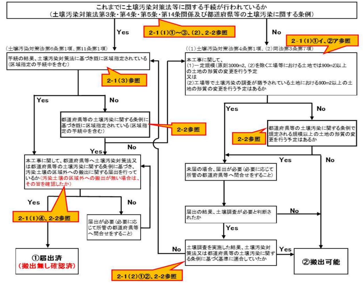
土壌汚染対策法等の手続の確認フロー（記載例1）
