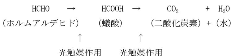
光触媒作用により酸化を促進し、有機物を最終的に無害な酸化物として気中に放出する
