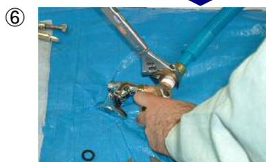
⑥ 三方分岐への固定は、作業しやすい丘組みで行う。
