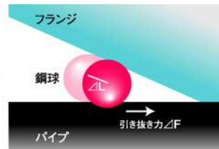
同時に鋼球はクサビ空間の  $\Delta L$  方向に移動して管壁に食い込む
