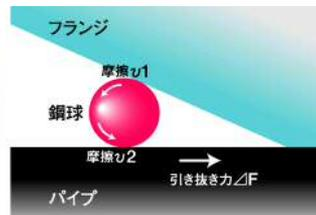
摩擦  $v_1$ 、 $v_2$  により鋼球に回転力が生じる
