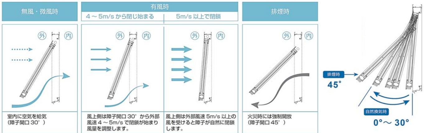
・CFDによる数値解析を行い、風力による障子開閉風速や流量係数を適切に設定できる。
