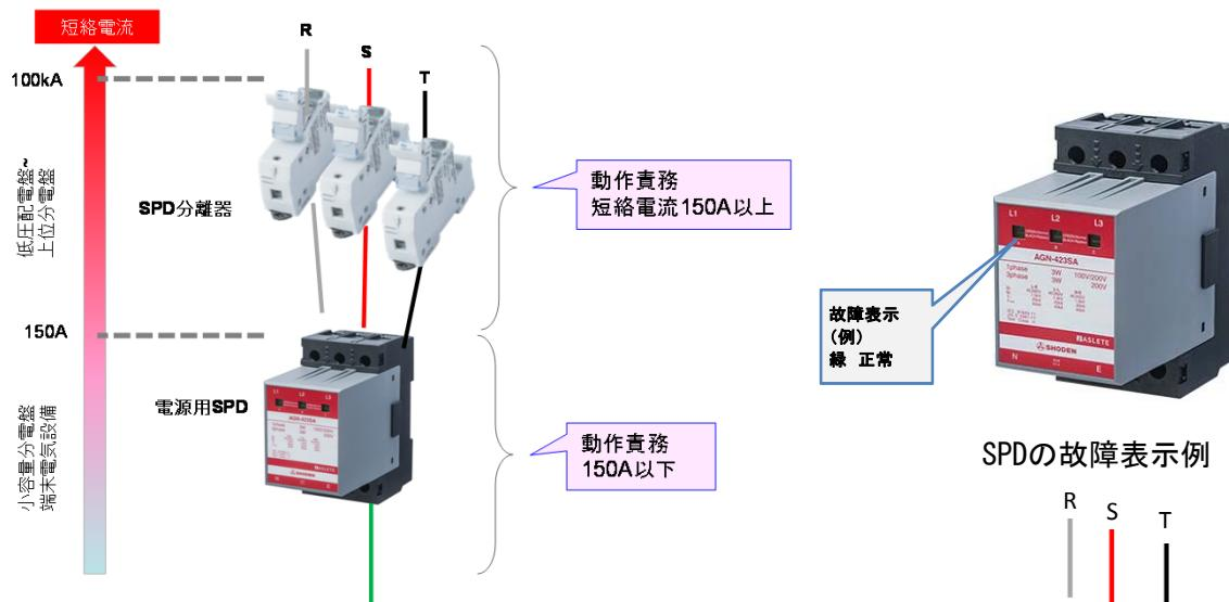
また、高密度に設計された分電盤等でSPD分離器を設置するスペースがない場合、分離器内蔵型SPDを使用することが有効である。
