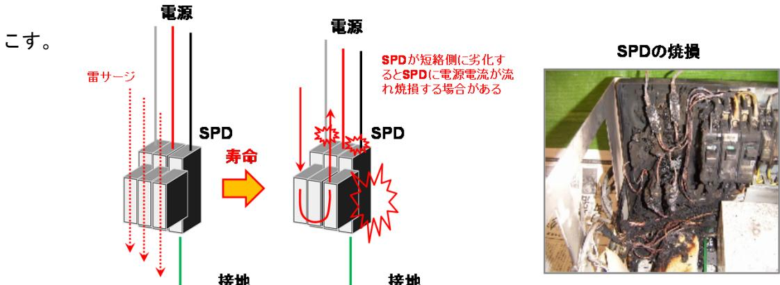
通常の電源用SPDは内蔵素子が短絡劣化した場合、自身の短絡保護機能が働くがSPDが保護できる電流は数百A程度であり、短絡電流が数十kAになるような電源の短絡保護は行えない。この場合、SPDと直列に遮断容量の大きなSPD分離器（一般的には専用のヒューズ）を設置する。この時、SPD分離器はSPDとの保護協調が非常に重要であるため、必ずSPDメーカーが指定する分離器を使用することが必要である。尚、SPDの交換時期は雷による動作頻度やSPDを通過する雷エネルギーによって様々なため、SPDの故障表示の点検によって判断する。
