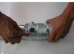
・ 締付ボルトはトルクレンチ使用の場合は7 Nm～8 Nmとし、その他のレンチを使用する場合はパッキングを押え込むまで締め付ける。</p> |               |                      |       |           |
