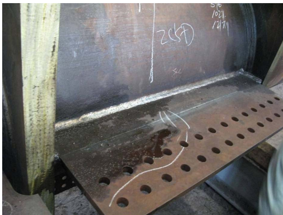
スパッタ付着防止剤が塗布された摩擦面
