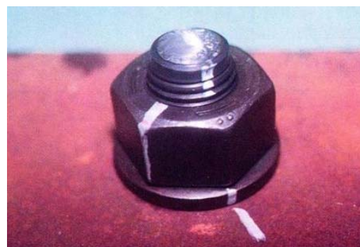
本締め完了時
