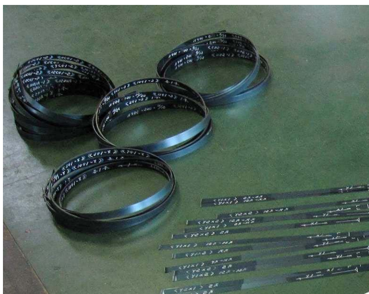
現現場でシナイに組立部材位置を記入
