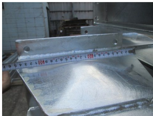
水分のためにめっき膨れした例
