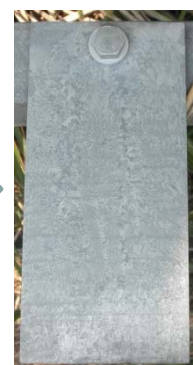
同一試験体の経年変化による光沢の低下
