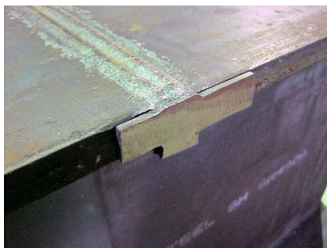
エンドタブ切断後、グラインダ仕上げの例※
