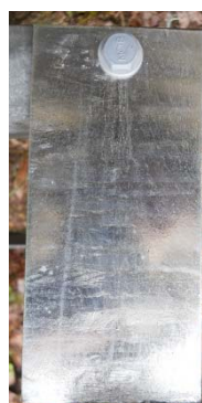
同一試験体の経年変化による光沢の低下
