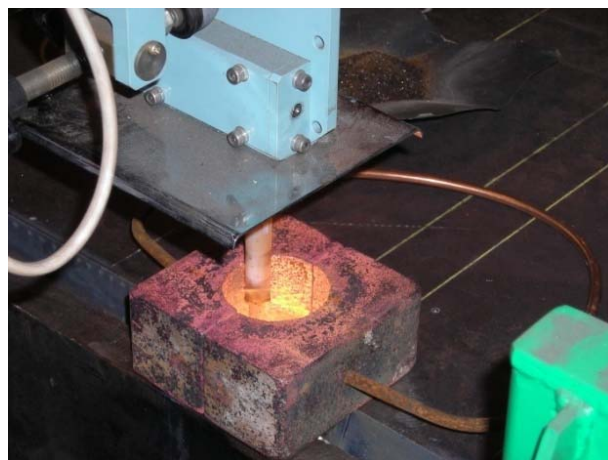
エレクトロスラグ溶接
