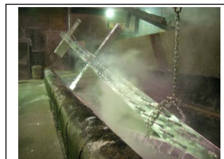
飛行機梁のめっきの例
