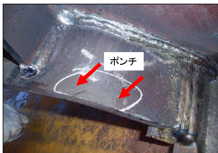
ハンチで曲げ加工される外面 (写真はポンチを打って曲げ加工された後)
