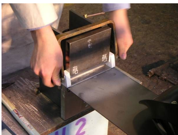
溶接前(代替エンドタブ取付け)
