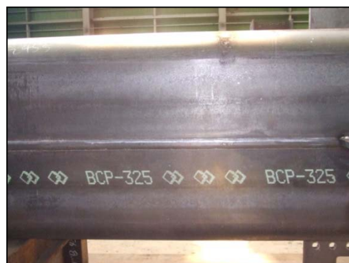
冷間成形角形鋼管(BCP325)
