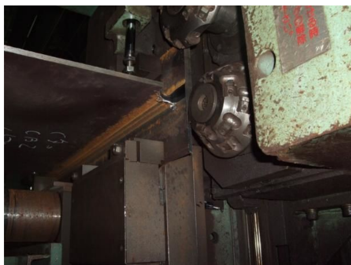
30°レ形開先に対応できる開先加工機
