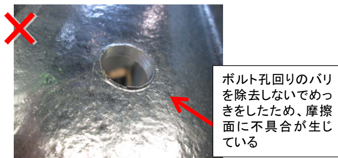
ボルト孔回りのバリ除去不良の例
