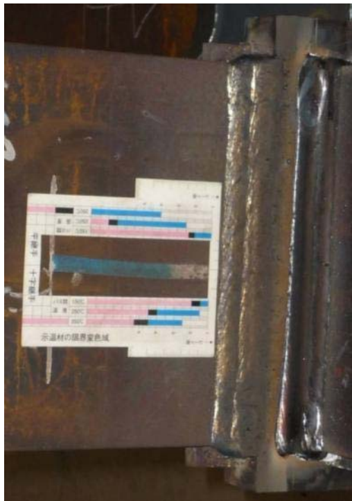
示温塗料を塗布した使用事例
