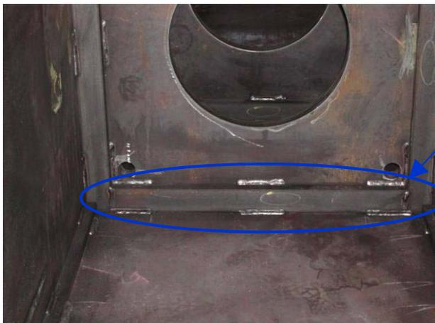
(注) 本溶接の一部となる組立て溶接に使用する溶接材料の選定にあたっては、以下の点に留意します。
