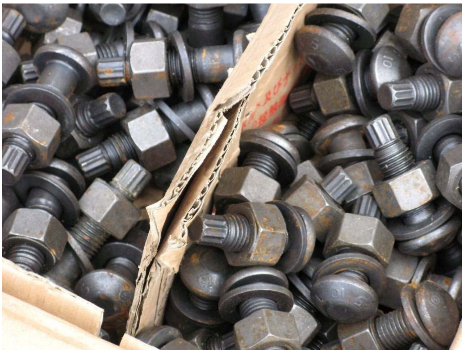
さびた高力ボルト
