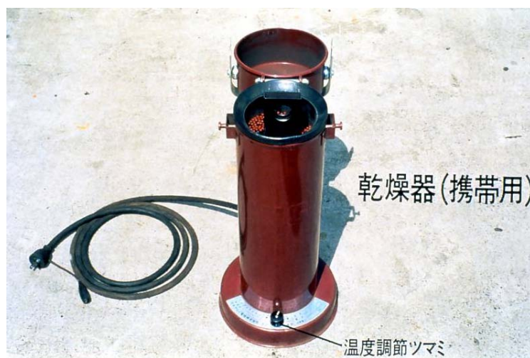
被覆アーク溶接棒の携帯用乾燥器
