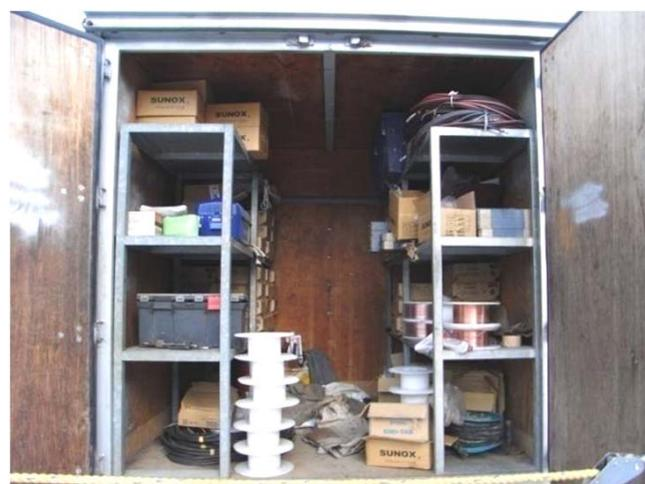
溶接材料保管用のコンテナ
