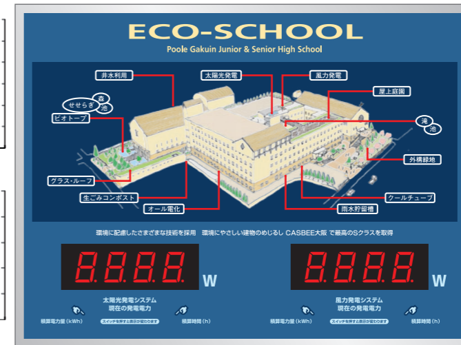
発電量表示パネル 環境配慮技術の説明を記載
