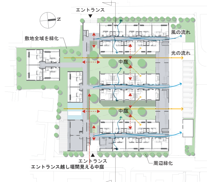
配置図：中庭を取り込んだ住棟配置
