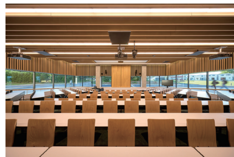
3方向に開く大教室/ボルトレスCLT耐震壁
