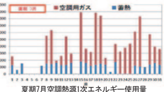
夏期7月空調熱源1次エネルギー使用量
