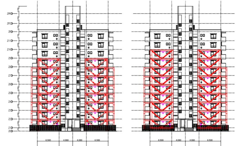
(a) 摩擦ダンパー使用 (b) ブレース型鋼材ダンパー使用
