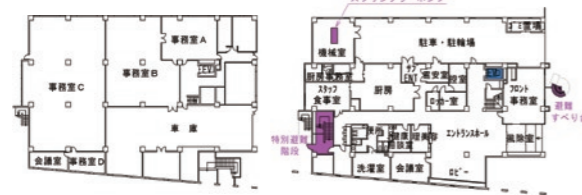
1階平面図（左 改修前 / 右 改修後）
