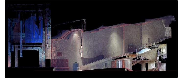
図-4 3Dスキャナーによる計測結果(断面)
