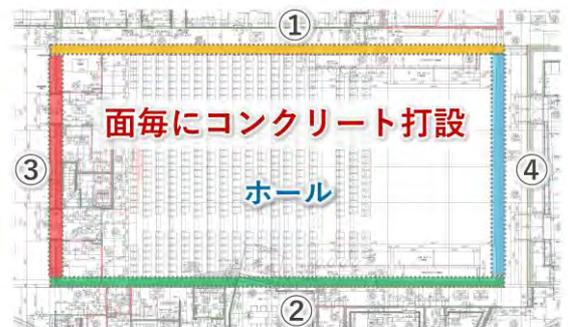
図-9 ホール壁コンクリート打分け(平面)
