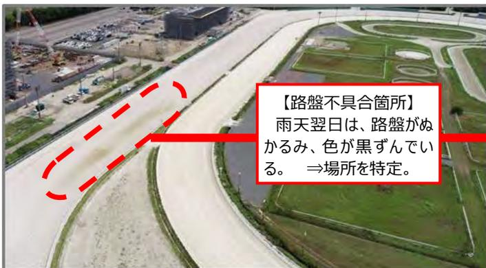
写真-5 ドローン空撮による路盤厚が薄い箇所の特定
