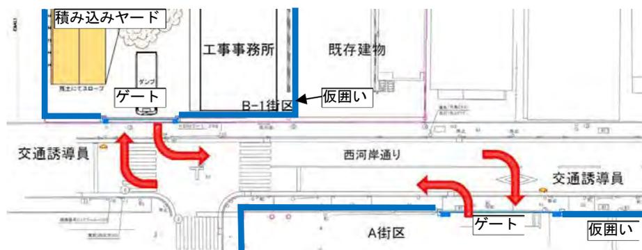
図-9 積み込みヤード（B-1 街区）への運搬計画
