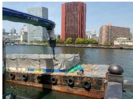
土砂運搬船の水質汚濁防止
