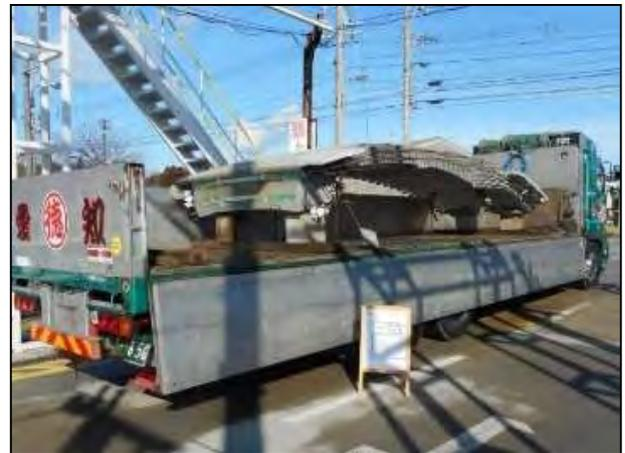
写真-9 最大寸法PCa版（2段目運送状況）
