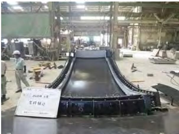
写真-19 鋼製型枠底盤
