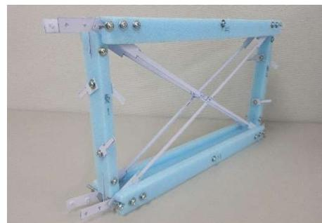
写真7 発泡スチロールによる簡易模型
