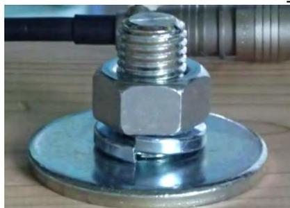
写真10 木痩せ時のボルトのゆるみ状況
