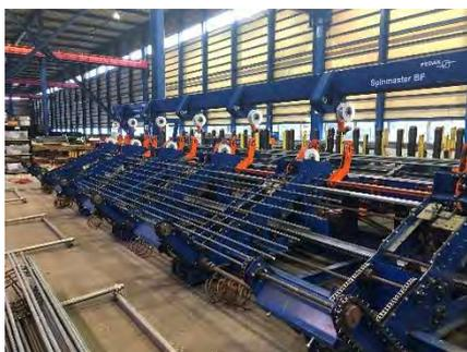
写真-6 ロールマット製作機械
