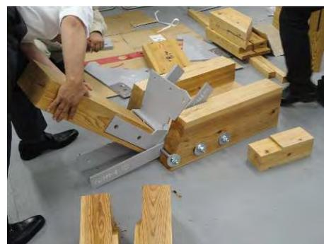
写真8 接合部のモデル作成
