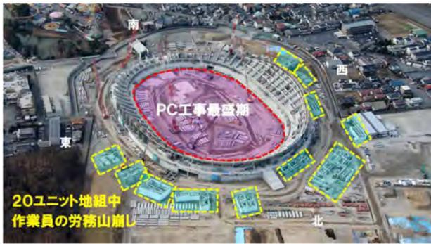
写真-6 屋根鉄骨建方開始時の状況 (2019年1月)
