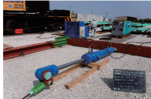
写真－12 油圧アンションジャッキ (s.t 1550・90 t)
