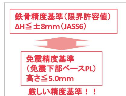
図-9 免震精度基準
