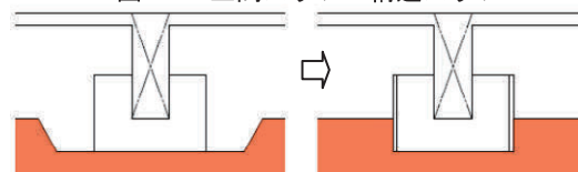
図-5-2. フーチング型枠埋め殺し
