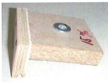
写真12 パチ隙間用治具
