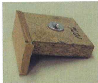
写真13 壁取り合い用隙間治具
