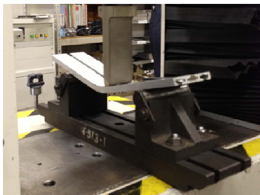
写真3 TN-レールの試験状況
