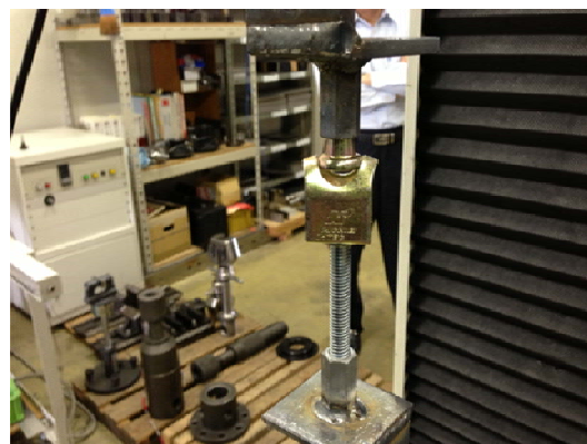
写真4 ピン構造部材の試験状況
