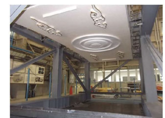
写真 4 振動実験の試験体
