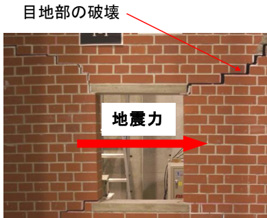
写真2 面内地震力による目地破壊形状
