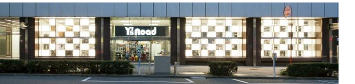
図-5 1階ショーウィンドウ：格子状鋼板パネル補強工法（耐震市松）
