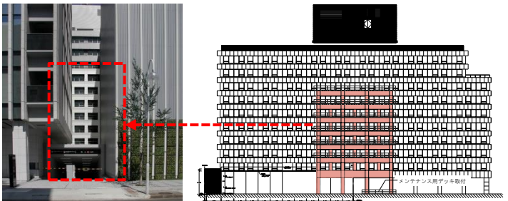
図-6 西側外壁部：SRC造外殻フレーム工法
