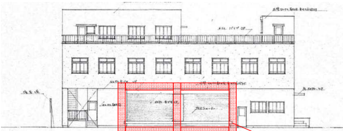
図－4 北側補強立面図
