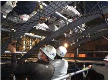
写真5 落下防止ネット载荷試験
