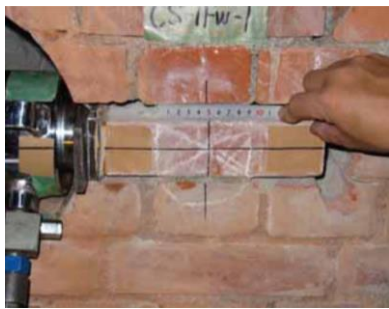
（ジャッキによる押し抜き試験）
