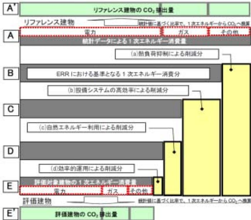
図 -1-2 CASBEE-新築の運用段階のCO<sub>2</sub>排出量の算定方法のイメージ
