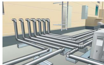
例) 屋外冷媒配管ラッキング
