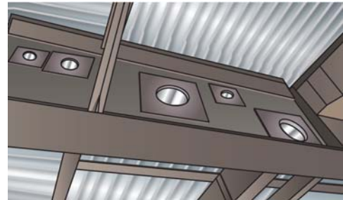
鉄骨梁スリーブの例
