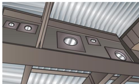
鉄骨梁スリーブの例
