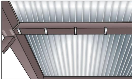
吊下固定用補助材取付用ピースの例
