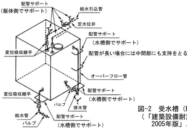
図-2 受水槽（FRP製）の配管支持例
