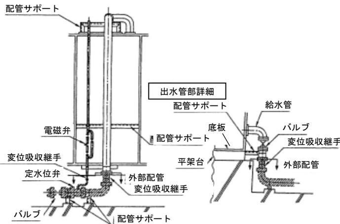
図-3 受水槽（FRP製）の出水管部詳細図
