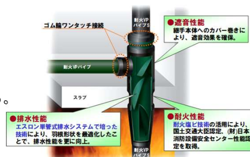
図2 耐火プラAD継手
