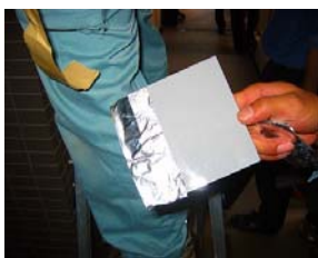
写真-5 隙間充填用の塩ビプレートの外観
