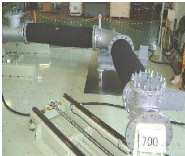
限界変位試験 免震量500mm用を700mmまで変位
