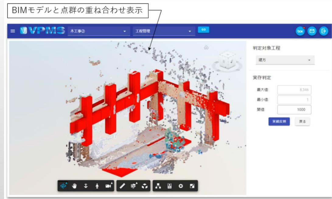
BIMモデルと点群データの重ね合わせによる実存判定
