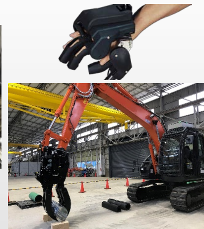
力触覚を利用した遠隔施工への活用
