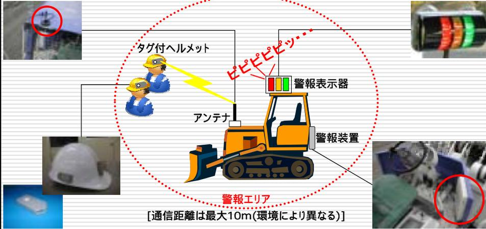
警報表示で重機オペレータに気づかせ接触事故の軽減を目指す
