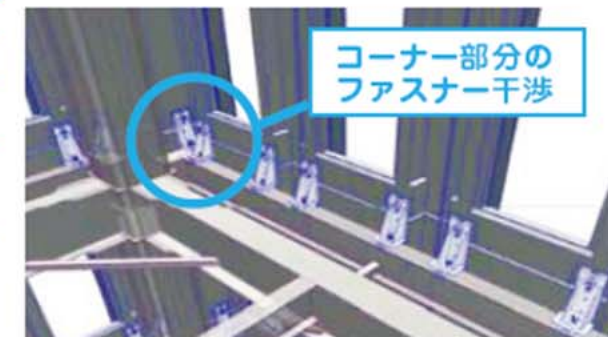
鉄骨と PCa ファスナーの調整例
