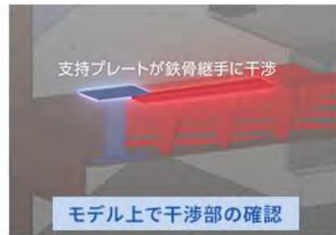
昇降機設備では、主に鉄骨部材の干渉チェックを実施
