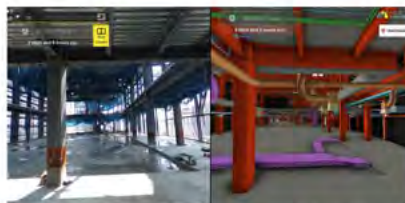
現地写真とBIMモデルを用いた進捗管理
