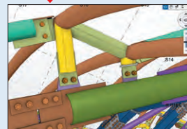
巻貝棟： 下部鉄骨とのジョイント例
