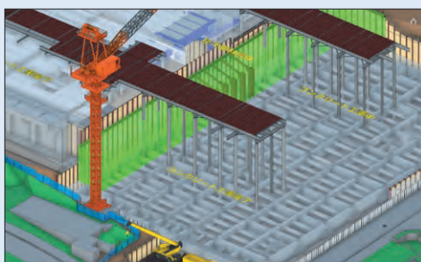
概略モデル(元請で作成) * 設計図より構造モデル作成
