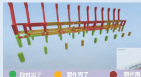
StreamBIMで施工管理における進捗管理を実施
