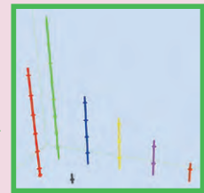
足場建地部材の色分け
