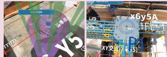
杭頭補強筋位置確認
