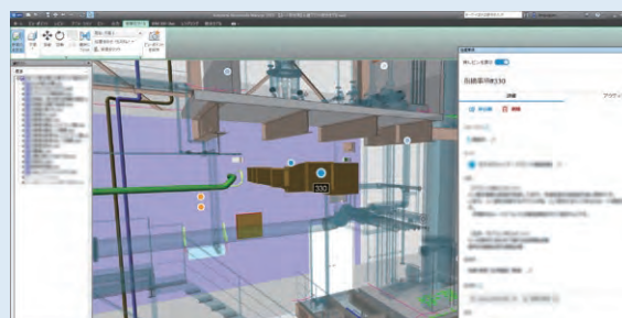
Navisworksでの空間調整・干渉チェック (BIMユーザー)
