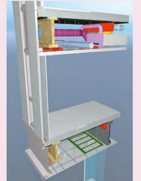
外装デジタルモックアップ: 外装ガラリ廻りの外装材・鉄骨・耐火被覆・設備ダクトまで入力
