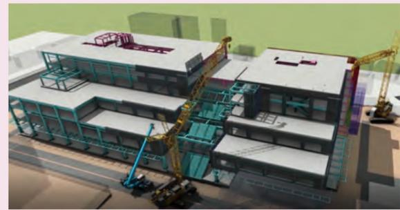
鉄骨、揚重機、外部足場、外壁PCaを統合して4D検討
