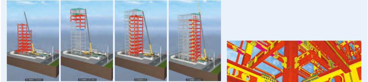
鉄骨建方ステップモデルにより建方時の支障を可視化
