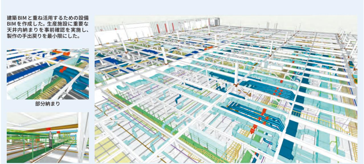
建築 BIM と重ね活用するための設備 BIM を作成した。生産施設に重要な天井内納まりを事前確認を実施し、製作の手戻りを最小限にした。
