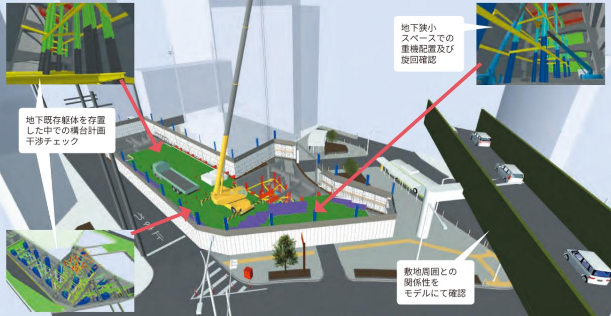
地下狭小スペースでの重機配置及び旋回確認
