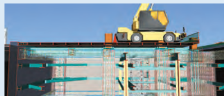
施工計画モデルを統合し、配筋方法等の検討を実施
