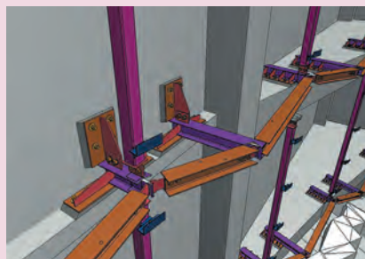
既存躯体と鉄骨取り合い②
