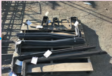
④自動加工機で加工後の鉄筋 (Revitからデータ連携)
