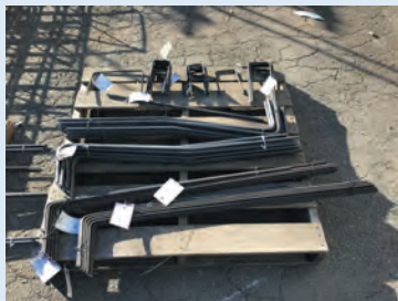
⑤自動加工機で加工後の鉄筋
