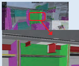
遮音壁の納まりを3Dモデルで検討
