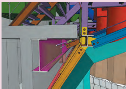
既存躯体と鉄骨取り合い①
