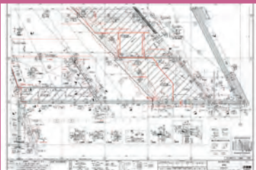
躯体モデルを利用した型枠展開図の作成
