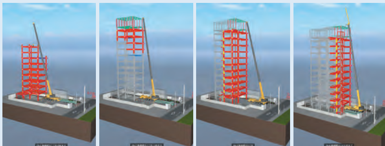
鉄骨建方ステップモデルにより建方時の支障を可視化
