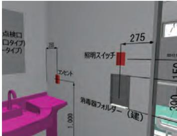
各寸法と機能を明記した3D総合図用モデル
