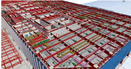
鉄骨-設備-内外装の統合モデル
