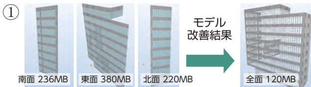
CW全面のファイルサイズの軽量化による操作性の向上
