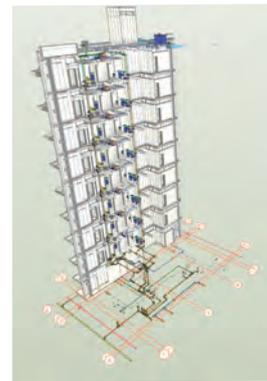
設計段階で設備施工図の作成
