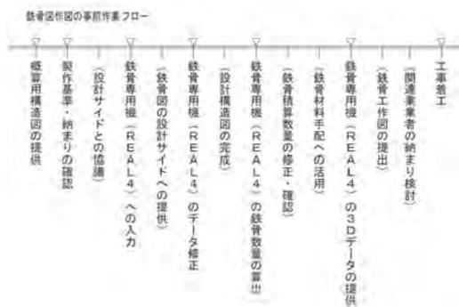
鉄骨図作図 事前作業フロー
