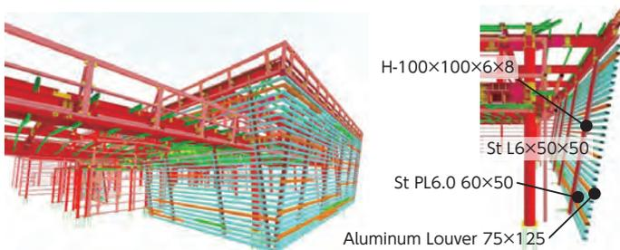
鉄骨モデルとルーバーモデルの重ね合せ 製作レベルの納まり調整
