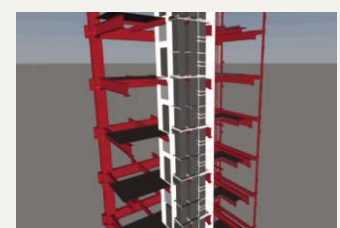
排気ボイラの施工 シミュレーションに よる安全対策計画
