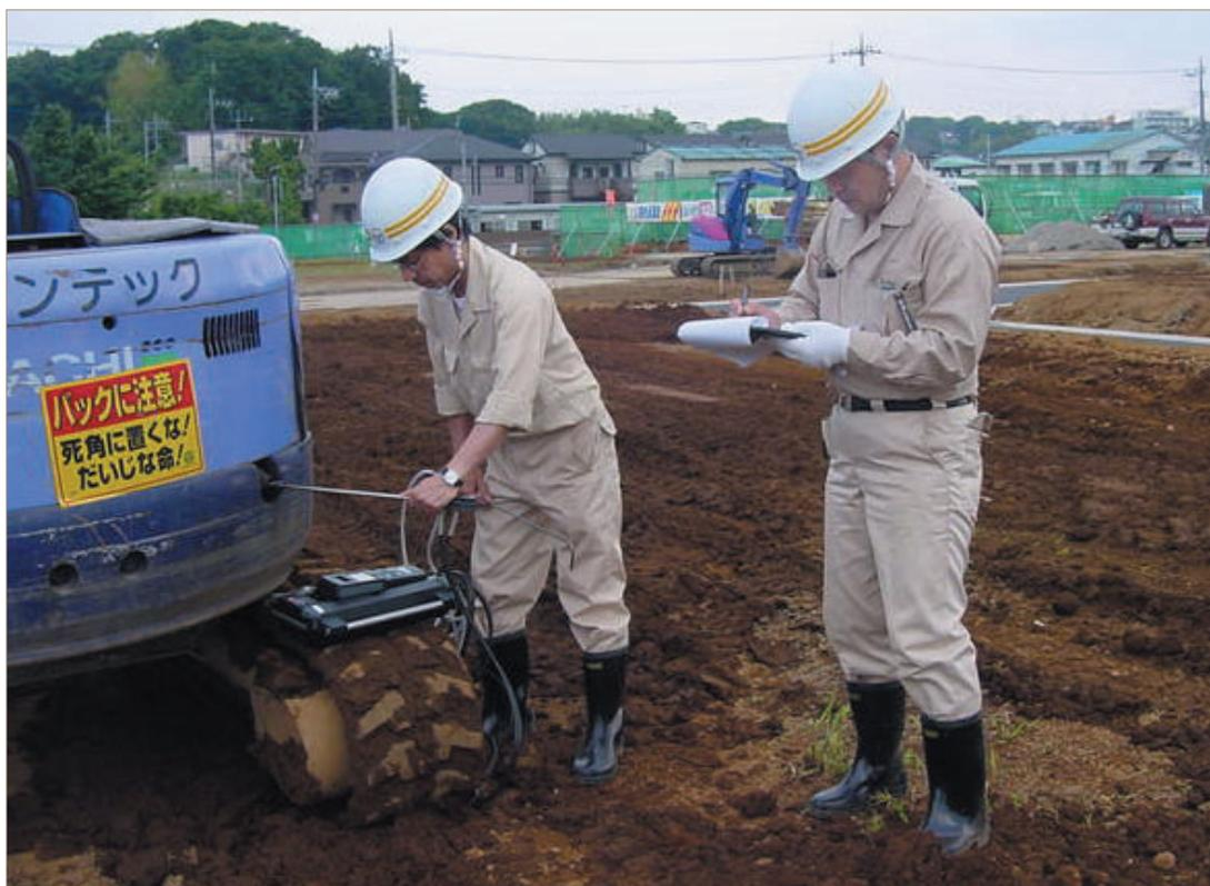
排ガス分析計による測定
